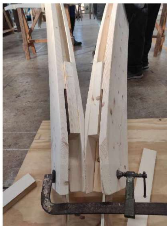
Incastro all'origine della doppia trave accoppiata che compone le strutture
