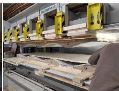
Studio e creazione di prototipo di 'macchinario' per la termo-formatura dei pannelli.
