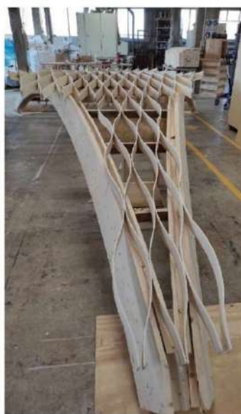
Lavorazioni in corso per assemblaggio maglie alveolari
