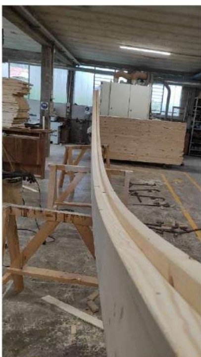
Prototipo di composizione della trave singola in legno abete
