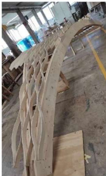
Lavorazioni in corso per assemblaggio maglie alveolari
