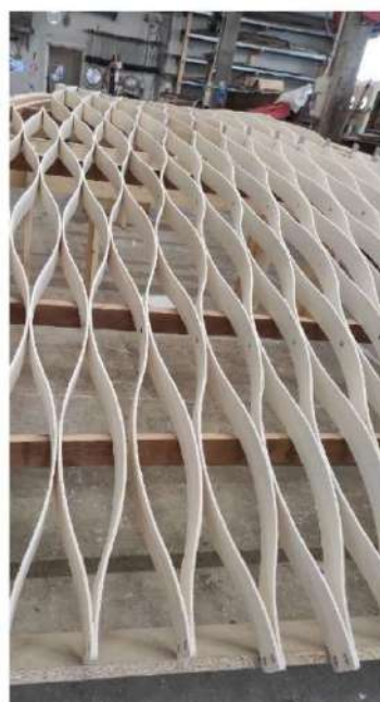
Lavorazioni in corso per assemblaggio maglie alveolari
