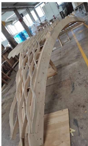
Lavorazioni in corso per assemblaggio maglie alveolari
