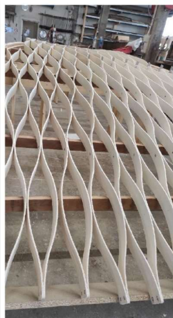
Lavorazioni in corso per assemblaggio maglie alveolari
